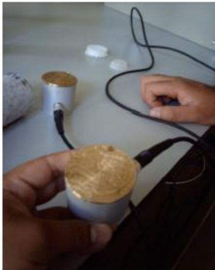
Figura 27. Ensaio possíveis para a medição da velocidade de propagação de ultra-sons, de acordo com a posição relativa dos transdutores.
