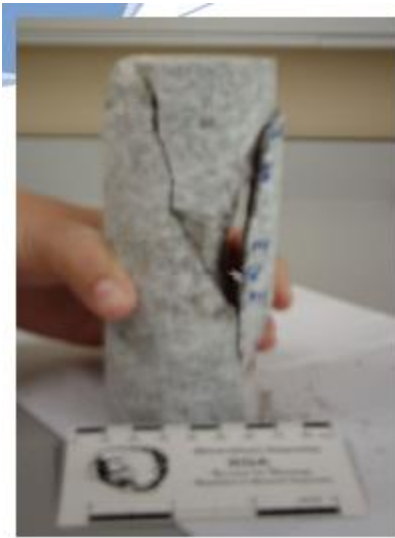
Figuras 22,23 e 24. Amostras pós-rotura com fracturas que fazem entre 30^\circ e 45^\circ com a direcção da aplicação da pressão.
