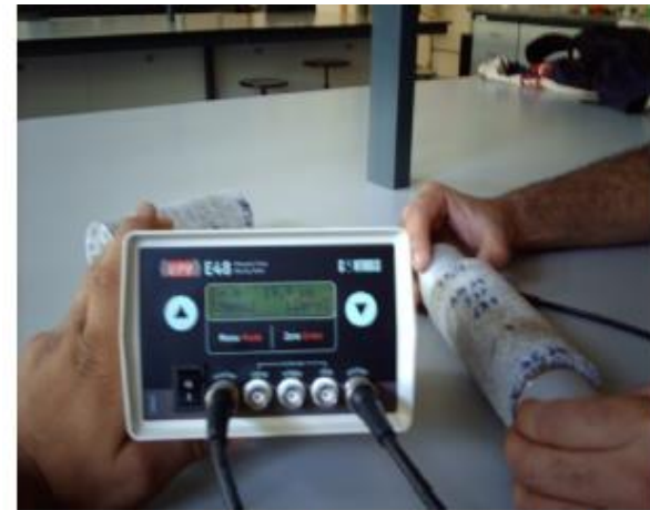
Figura 29. Aplicação do gel nos transdutores, de forma a criar vácuo entre estes e a amostra, pois os impulsos ultrasónicos não se propagam no ar
