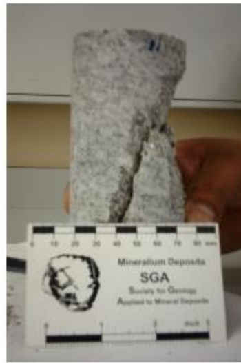
Figuras 22,23 e 24. Amostras pós-rotura com fracturas que fazem entre 30^\circ e 45^\circ com a direcção da aplicação da pressão.
